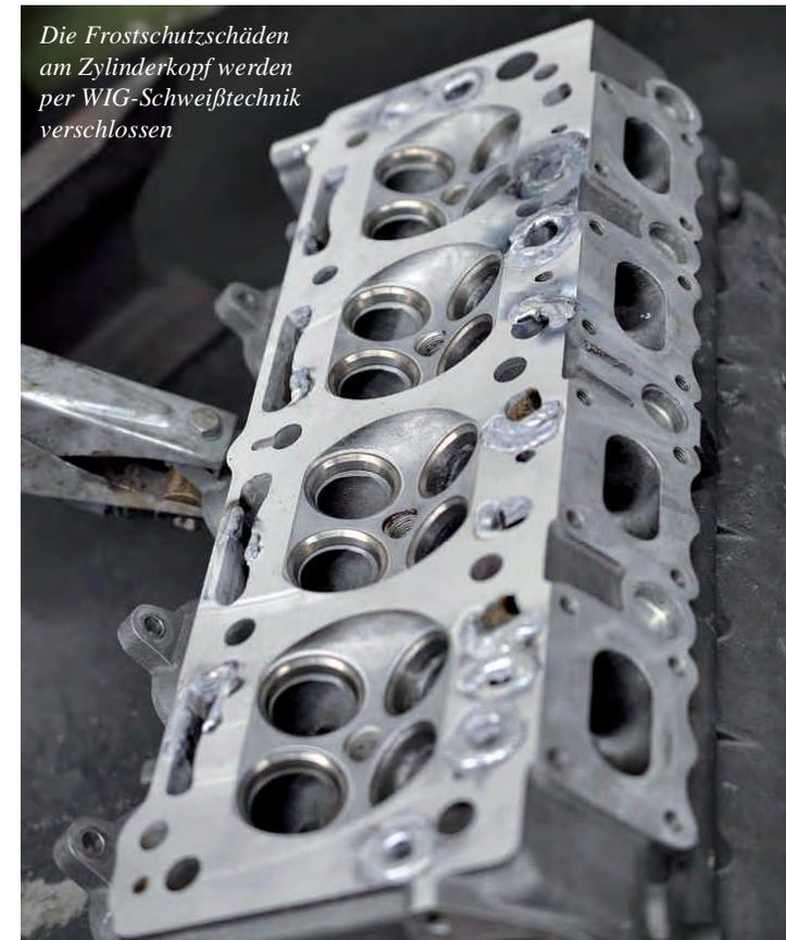
Die Frostschuttschäden am Zylinderkopf werden per WIG-Schweißtechnik verschlossen
